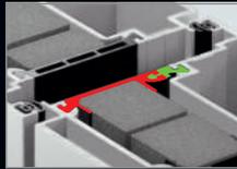
Der **geteilte Isoliersteg** des Flügelrahmens nimmt den durch Temperaturunterschiede entstehenden Schub auf und **minimiert so den Bimetalleffekt**
